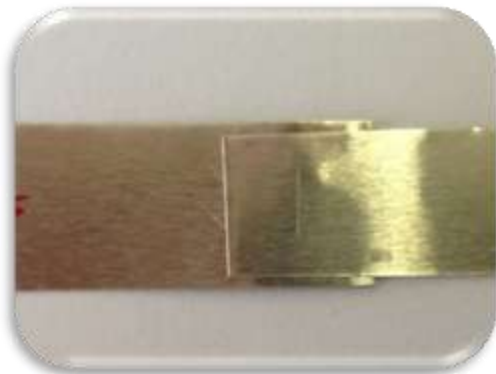
50 um thick Al Battery Foils
